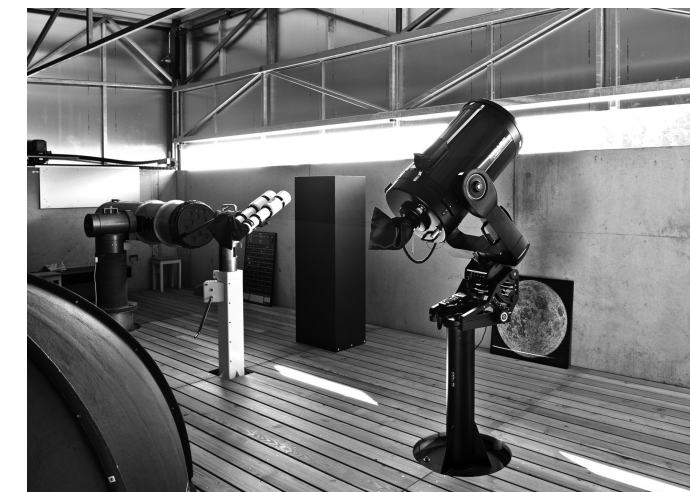
Die beiden Hauptteleskope verfügen über unabhängige Fundamente
